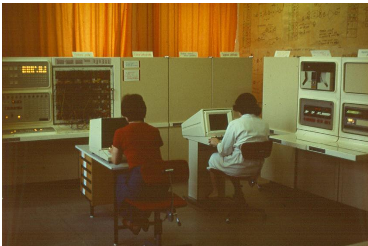
Hybridný počítač PACER 600 firmy EAI, USA v Počítačovom laboratóriu ÚTK SAV - vľavo analógová časť a vpravo číslicová, v strede hybridné prepojujacie prvky, 1978
