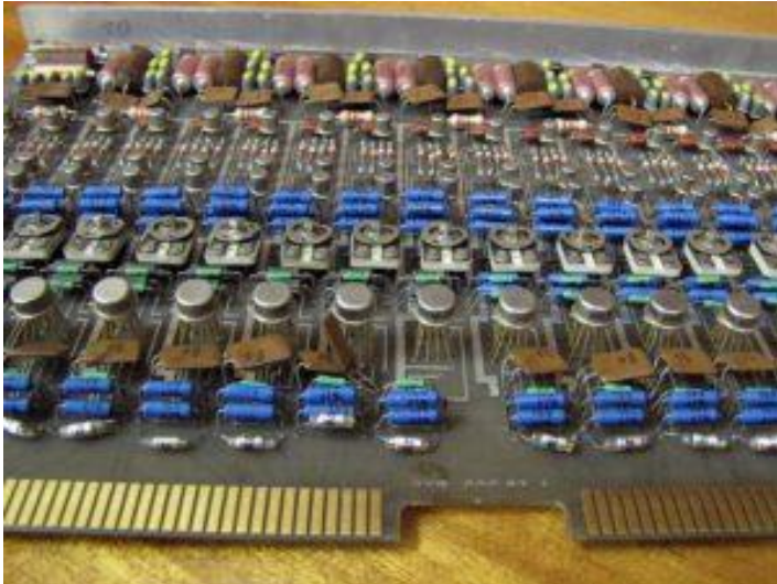
Obr. 3: Z elektronického hľadiska najnáročnejšou súčasťou pamäťového bloku 4K18 bola táto doska 18 snímacích zosilňovačov (pre každý bit pamäti bol určený jeden zosilňovač)
