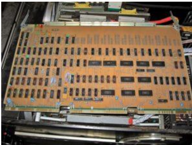
Obr. 15: je pohľad na dosku riadenia POP CM 3511 M.1 typu ECC. K doske riadenia bolo možné pripojiť 1 až 8 dosiek pamäťového poľa s prvkami 4116 alebo 1 až 4 dosky pamäťového poľa s prvkami 4164. Maximálna kapacita pamäti bola 4 MB.
