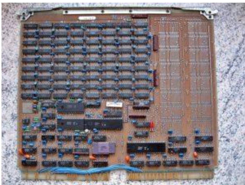
Obr. 16: Doska kombinovanej DRAM a EPROM pamäti vyvinutá pre mikropočítač M 16-22, ktorý umožňoval adresovať OP do 4 MB.
