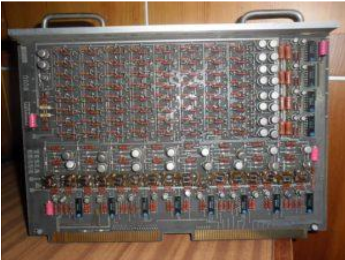
Obr. 4: Zostava planárneho pamäťového „kvádra“ 4K18 a 2 dosiek súradnicových výberov.
